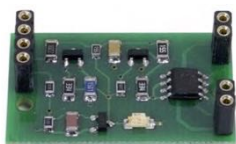
Рисунок 64 – Изолятор короткого замыкания 788612
