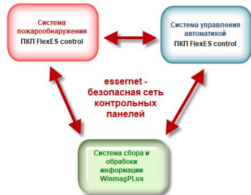
Рисунок 128 – Концепция реализации системы пожарной автоматики
