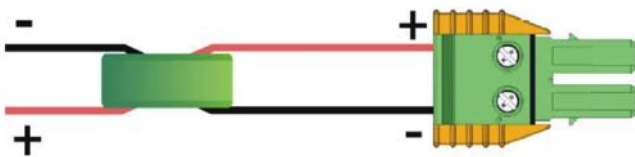
Рисунок 55: Установка ферритовых тороидов
