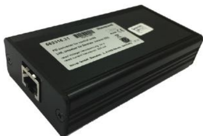
Рисунок 21 – Оптоволоконный конвертер OIM, оптоволоконный конвертер DCS-O
