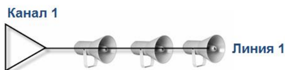
Рисунок 56 – Моноканальная схема подключения
